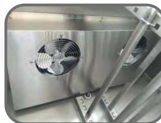
Evaporador de tiro forzado con recubrimiento anticorrosión.
