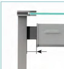
**Todos los elementos en contacto o próximos a los alimentos** deben ser fácilmente accesibles para su higiene. Hemos separado ligeramente el soporte de la pantalla, para que las operaciones de limpieza sean cómodas y eficientes.
