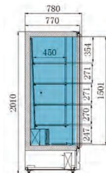
Sistema de distribución del frío integrado en todo el armario, desde la parte inferior del armario, parte posterior y superior lo que maximiza una homogeneidad de la temperatura, minimiza las pérdidas energéticas y la aparición de vahos
