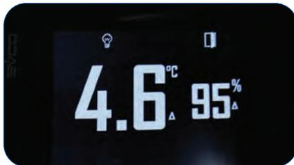
Termostato y humidostato electrónico para un control preciso de la humedad interior y la temperatura.
