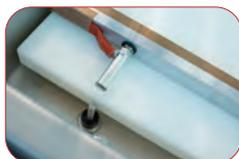
Barra de soldadura extraíble para facilitar limpieza.
